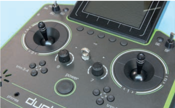
Sämtliche Bedienelemente sind hochwertig verarbeitet, die beiden Drehpotis haben eine Rastung und eignen sich beispielsweise sehr gut für die Lautstärkeregelung
